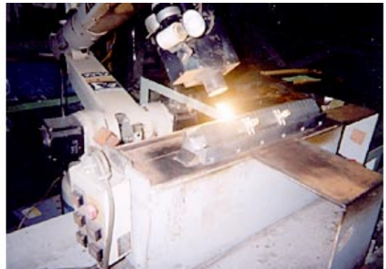
YAG レーザ溶接状況
